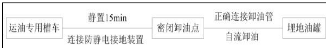
图 3.2.2-12 柴油卸车工艺流程图
