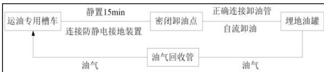
图 3.2.2-11 汽油卸车工艺流程图
