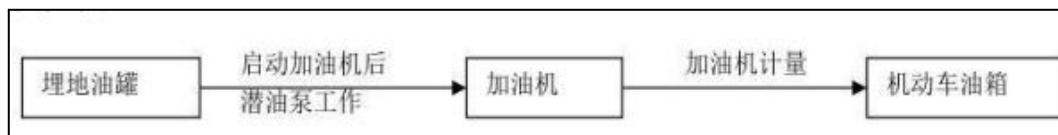
图 3.2.2-14 柴油加油工艺流程图
